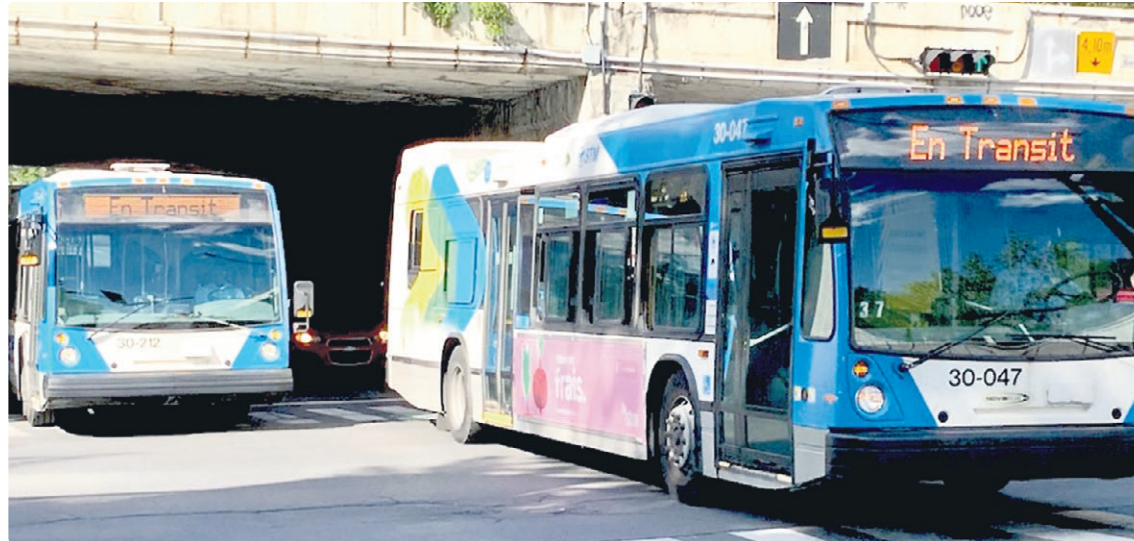
Regardez bien la différence entre ces deux bus. En inversant les couleurs comme sur l'afficheur de ligne du bus qui est à l'arrière sur cette photo, les clients peuvent voir de plus loin que le bus qui approche est en transit. Ces couleurs inversées sont visibles autant de jour que de nuit.
