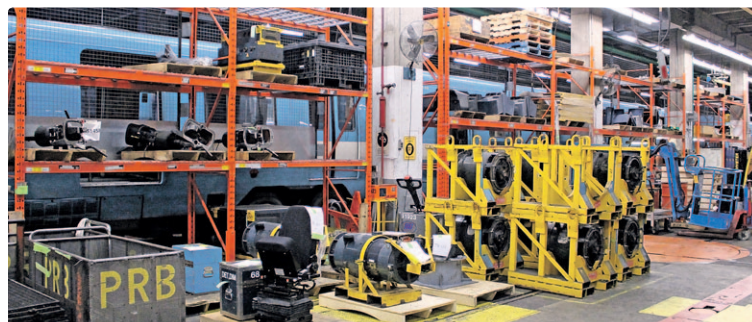
L'entreposage des pièces des MR-63 et des MR-73 : l'entretien mineur des voitures exige un stock important de pièces de remplacement : moteurs, pneus, sabots de freins, dispositifs d'ouverture de portes, etc. Puisqu'on effectue l'entretien de deux types de matériel roulant, soit les MR-63 et les MR-73, il a fallu dans bien des cas prévoir de l'espace supplémentaire pour des pièces différentes.
