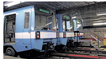
Un garage annexé à l'atelier permet de garer huit trains de neuf voitures, soit deux trains de 152 mètres (500 pieds) de longueur sur chacune des quatre voies. C'est le seul endroit dans le réseau où un atelier et un garage se côtoient.
