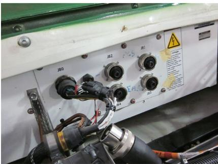
Durant la période d'essais à la STM, l'autobus Citelis a subi quelques pannes entraînant l'immobilisation de l'autobus. La plupart des pannes en service du Citelis ont été causées par des connections défectueuses sur le module de batteries (ESS). Trois des quatre connecteurs 600V étaient fissurés, et cela possiblement depuis le
