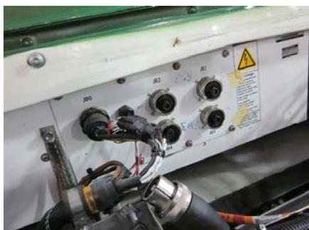
Durant la période d'essais à la STM, l'autobus Citelis a subi quelques pannes entraînant l'immobilisation de l'autobus. La plupart des pannes en service du Citelis ont été causées par des connexions défectueuses sur le module de batteries (ESS). Trois des quatre connecteurs 600V étaient fissurés, et cela possiblement depuis le
