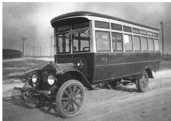
Les premiers autobus de la Montreal Tramways Company, en 1919, étaient en fait des camions transformés en autobus dans les ateliers de la compagnie. (Archives de la STM)
