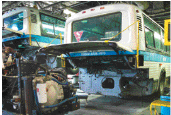
Un autobus en réparation à l'usine Crémazie. (STM)
