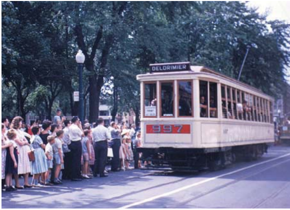
Le tramway 997 a vu le jour en 1910. Les tramways de cette série avaient la particularité d'avoir été achetés en pièces détachées puis assemblés aux ateliers d'Hochelaga de la Compagnie des tramways de Montréal.
