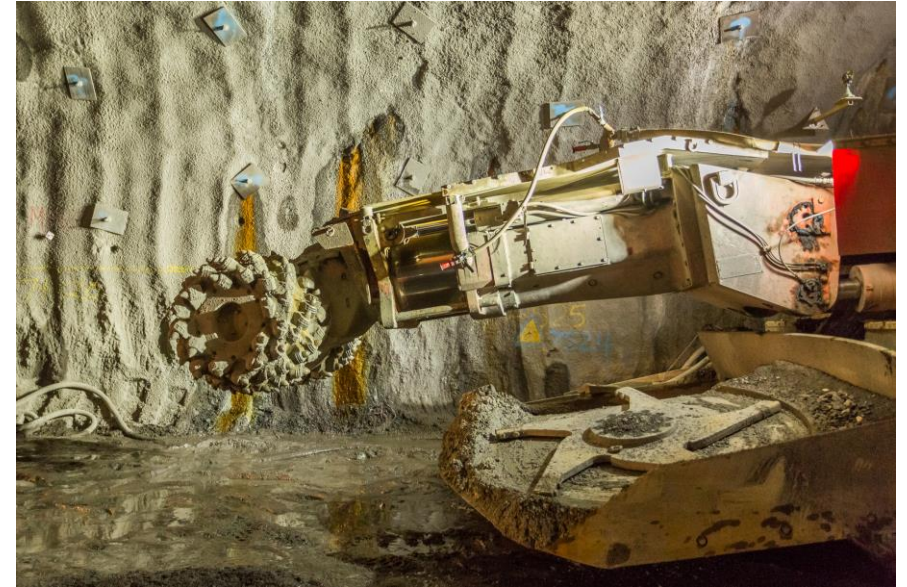
Machine nommée haveuse qui permet de broyer le roc et creuser des tunnels
